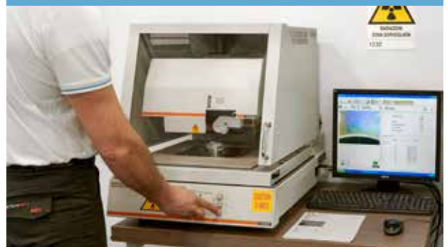
misurazione spessore via X Ray
